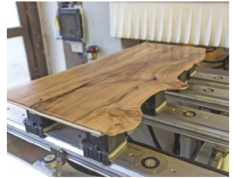
/ ... um danach in das CNC-BAZ eingespielt und als Grundlage für die Fräsbahnen genutzt zu werden.
