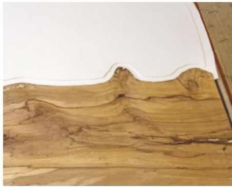
/ Um die Passstücke zu fertigen, wurden die Stämme gescannt und die Daten per CAD bearbeitet, ...
