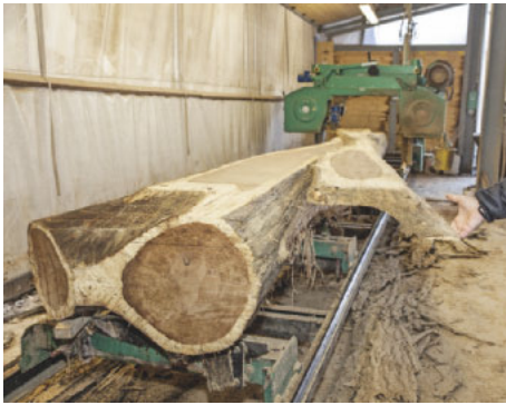
/ Die Sägefurniere werden an der Blockbandsäge eingeschnitten – hier ein verzweigter Eichenstamm
